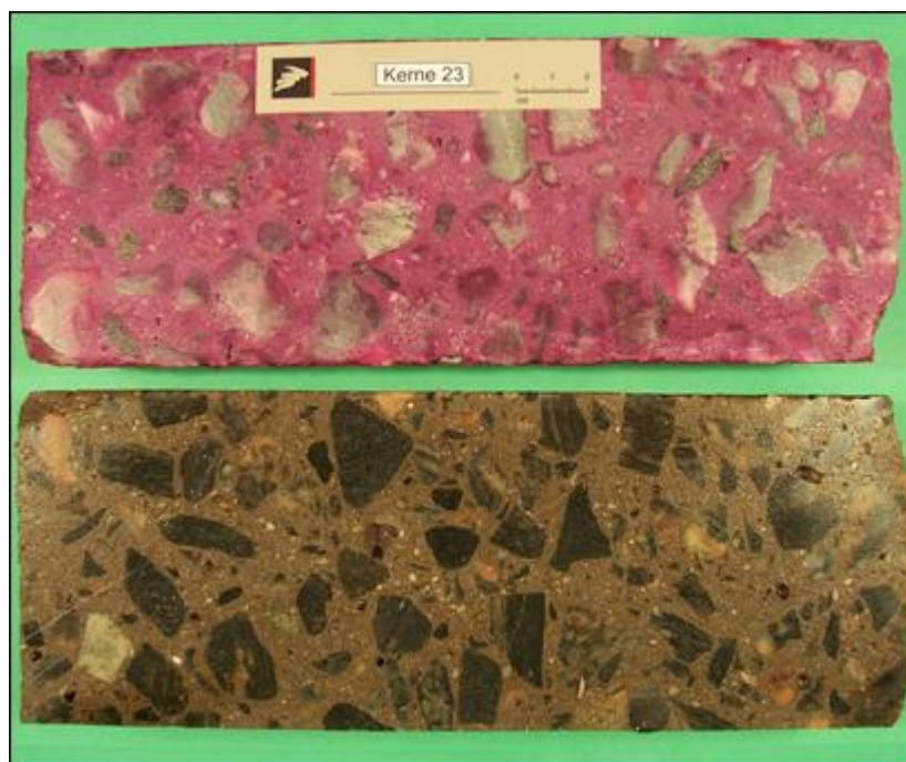
Figur 3 Betonens overflade er mod venstre. Øverste kernehaldel er sprøjtet med pH-indikator (phenolphthalein).
